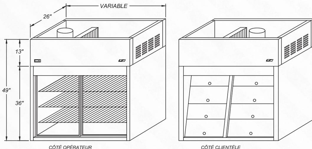
**APC-PB-CI**, tuyau réfrigération, drain et cordon électrique 6' sous l'armoire
